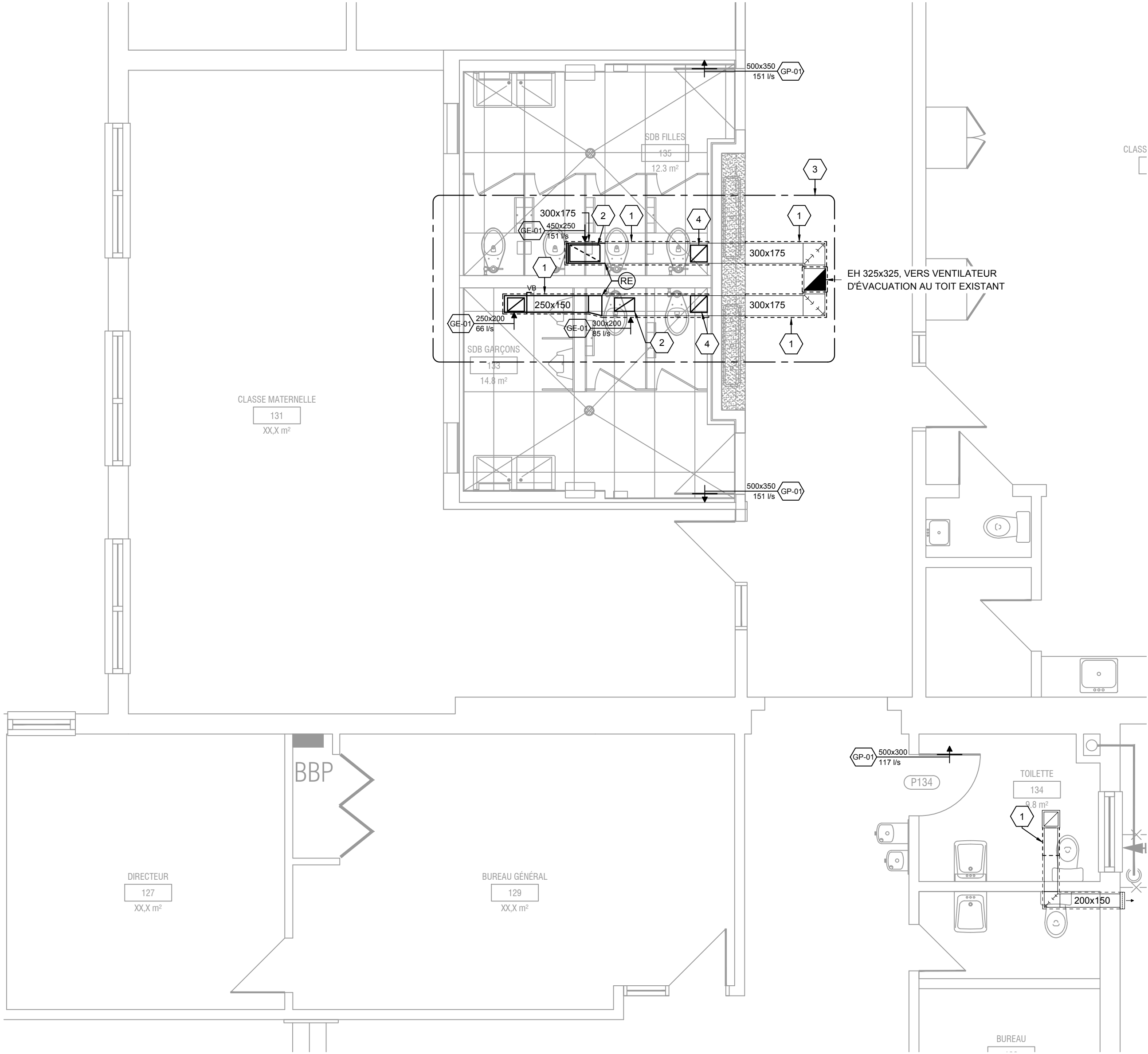
VENTILATION - RDC - RÉAMÉNAGEMENT
